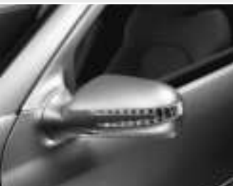
Rappel de clignotants en forme de flèche dans les rétroviseurs extérieurs ▲
